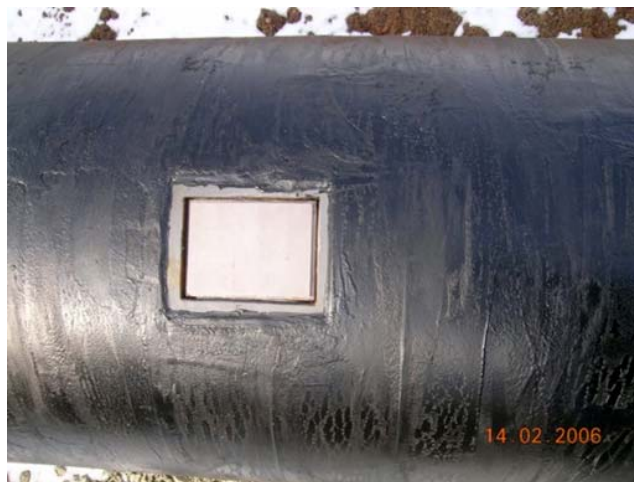
Bild 14 : Reduzierung Mantelreibung am Probepfahl mit bituminöser Beschichtung
