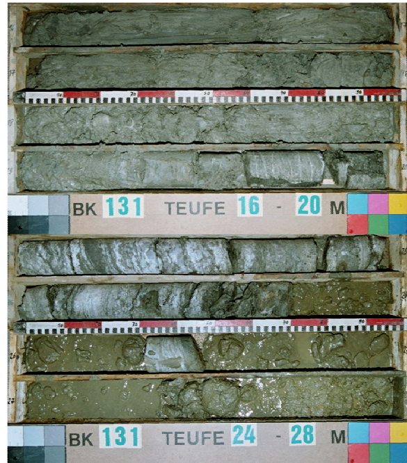
Beispiel für eine weit fortgeschrittene Auslaugung der Gipse (Achse 50 im Talgrund)
