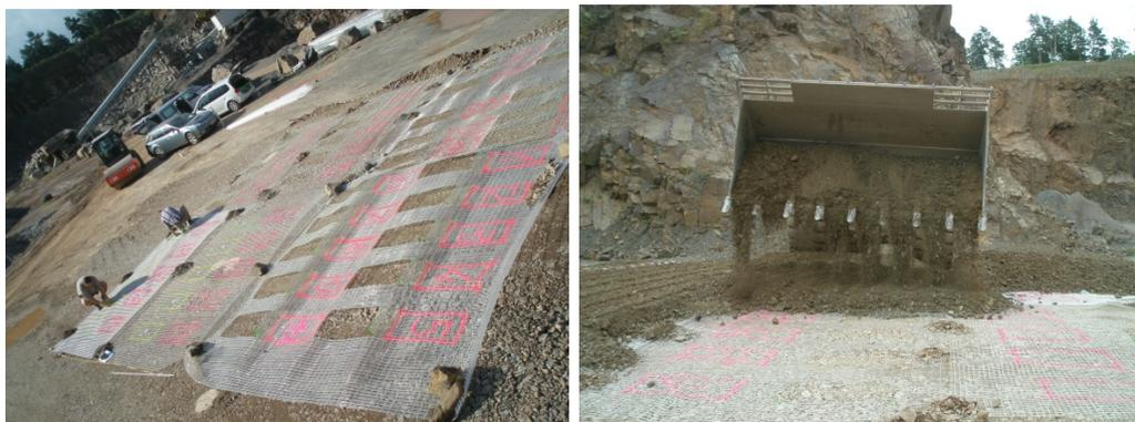
**Abbildung 6: Testfeld zur Ermittlung der Einbaubeschädigung, links: Übersicht über verschiedene Geogitterprobestücke; rechts: Einbau des Brechkorns 0/63 mm**
